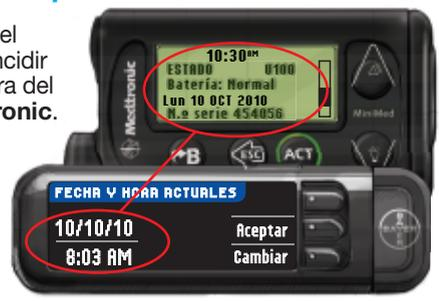
**Configuraciones adicionales del medidor**
