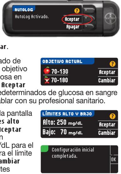
**NOTA:** Los Límites alto y bajo solo se pueden configurar fuera del intervalo Objetivo seleccionado. Los Objetivos solo se pueden configurar dentro de los Límites alto y bajo. Para obtener información adicional, puede ponerse en contacto con el Servicio de atención al cliente en el 1-800-348-8100, disponible 24 horas al día, 7 días a la semana.
