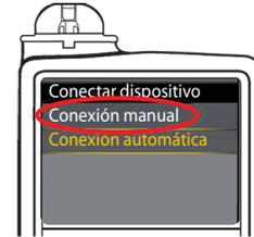
9. Coloque el medidor y la bomba uno al lado del otro. Seleccione **Conexión manual** en la bomba. Seleccione **Conexión man.** en el medidor.
