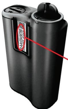
13. Dé la vuelta a la bomba. Compruebe que el número de serie en la parte trasera de la bomba coincide con el número de serie que aparece ahora en la pantalla del **medidor**.
