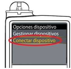
8. En el menú **Opciones dispositivo**, desplácese hasta **Conectar dispositivo**. Pulse el botón **Seleccionar**.
