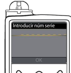
10. Coja la bomba. Introduzca en la pantalla de la bomba el número de serie (SN) que se muestra en el medidor. Utilice los botones arriba y abajo para seleccionar los caracteres y, a continuación, pulse el botón derecho para pasar al siguiente carácter. Siga pulsando para llegar al alfabeto. Pulse abajo para ir a la inversa (empezando por la "Z"). Pulse el botón **Seleccionar** después de introducir el último carácter del número de serie. Seleccione **OK** en la bomba.
